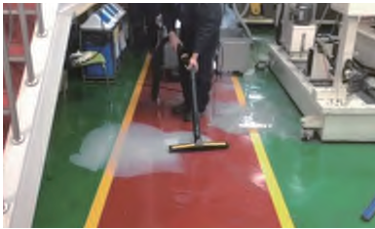
底面漏油及设备周边
