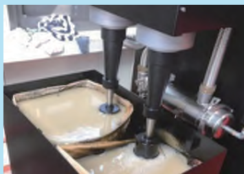
清除涡旋过滤出的铁屑
